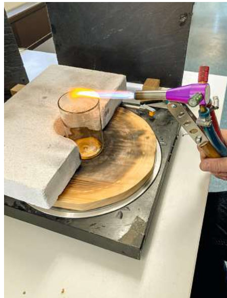
Auf dem drehbaren Plattenteller werden die Glasränder flammpliiert.
