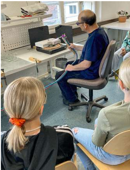
Auf dem drehbaren Plattenteller werden die Glasränder flammpliiert.
