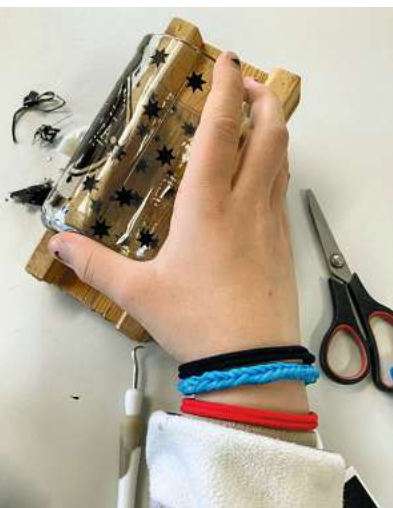
In Feinarbeit werden Klebemotive auf das Glas appliziert und nach dem Sandstrahlen wieder entfernt.
